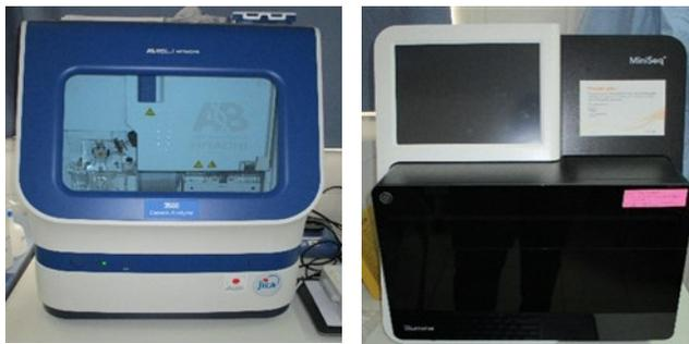
Au cours de l'exercice 2018, le projet a installé deux équipements de pointe: un séquenceur capillaire (ABI 3500, à gauche) et un séquenceur de nouvelle génération (Miniseq, à droite). Ces équipements renforceront les capacités de recherche du CERMEL.
