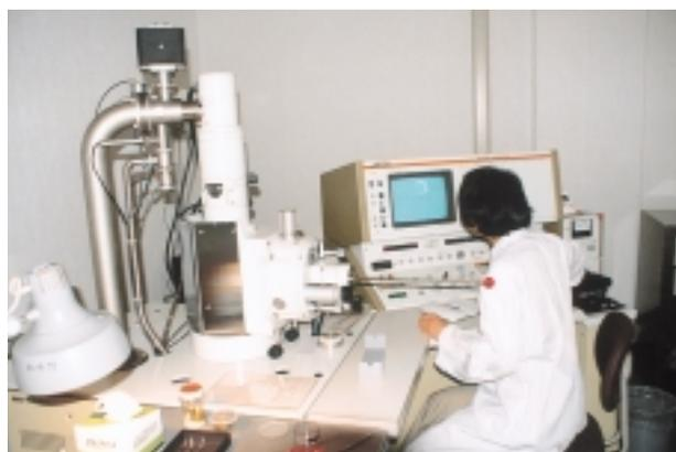
電子顕微鏡室の走査電子顕微鏡
